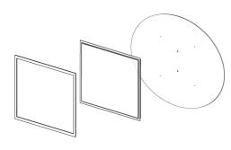
Cadre aluminium laqué de 3 mm pour collage sur un écran Paperflex aux formats A6, A4 et A3 (disposition Portrait ou Paysage). Plaque de support eliptique pour fixation directe sur le mur (sans entretoise) Le fond peut être traité d'une couleur différente de celle du cadre.
