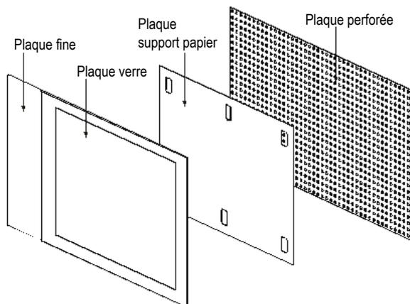
La solution Infinity Glass «Paperflex» comporte une plaques perforée en acier laqué de 1,2 mm, une plaques support pour le document en acier laqué de 1 mm et en façade, une plaques permanente laquée de 3 mm et un écran de verre pivotant et sérigraphié en gris 27-0052 sur la face interne.
