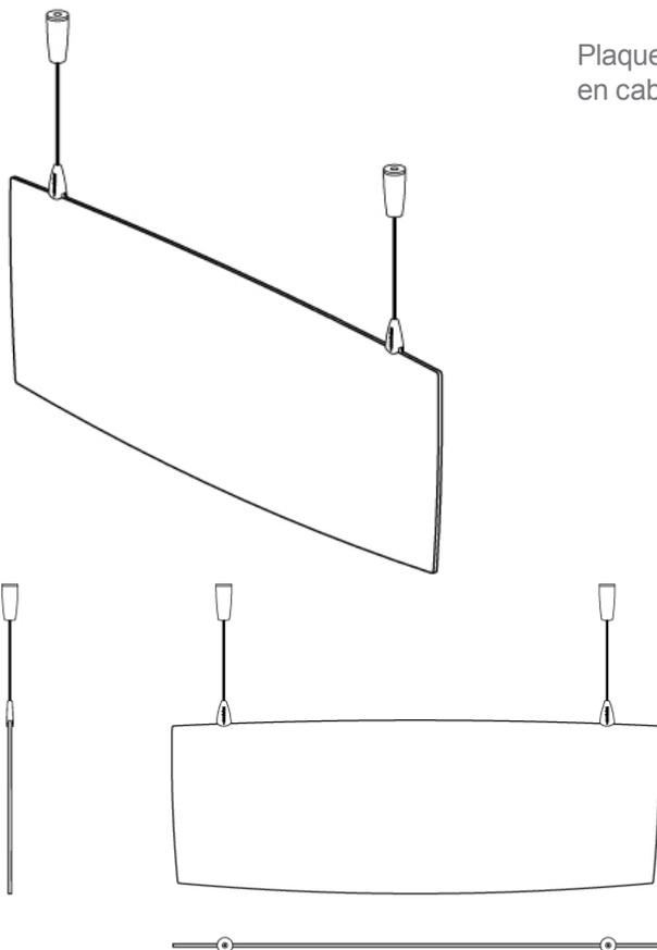
Plaques aluminium laqué de 3 mm avec kit de suspension en cable inox et cache crochet en polycarbonate injecté.
