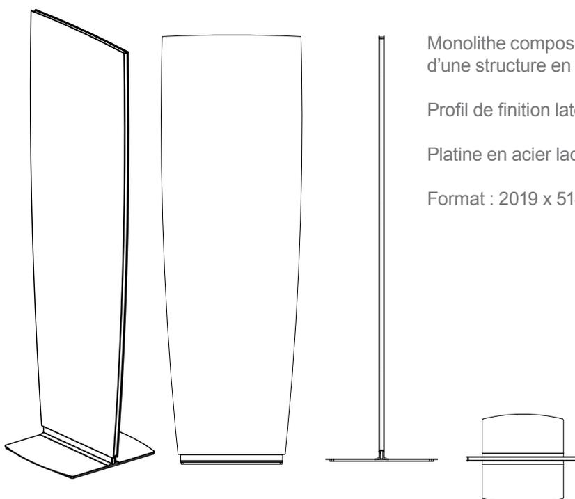
Monolithe composé de 2 faces en aluminium de 2 mm et d'une structure en forme de cadre acier.
