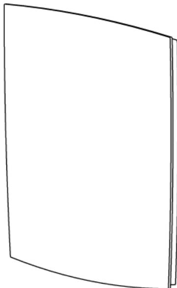
Plaques aluminium laqué de 3 mm avec clips de montage invisibles et entretoise en mousse de polyuréthane noire formant un écartement de 10 mm.
