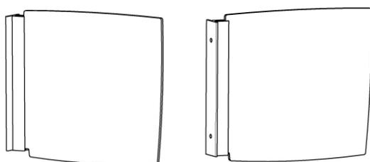
Plaques aluminium laqué de 3 mm avec kit de fixation latéral en aluminium extrudé laqué gris anthracite.
